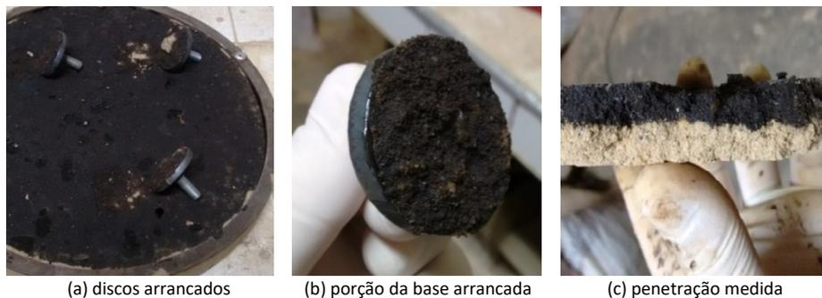
**Figura 2.** Ensaio de aderência por meio da resistência ao arrancamento da base imprimada
