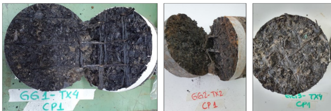
Figura 7. Rupturas de corpos-de-prova na interface entre geossintético e massa asfáltica
