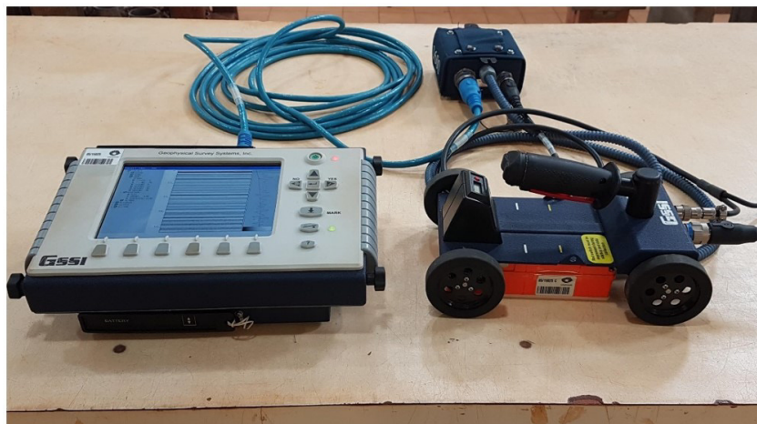
Figura 6. À esquerda, o sistema SIR-3000; à direita, antena modelo 5100 fixada em um “mini-carro” ( minicart ); ao fundo, caixa de controle da antena
