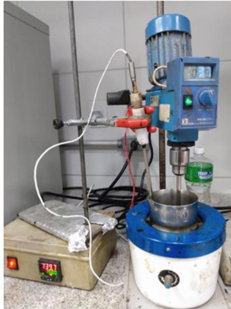
**Figura 2.** Misturador de cisalhamento utilizado na preparação das amostras.
